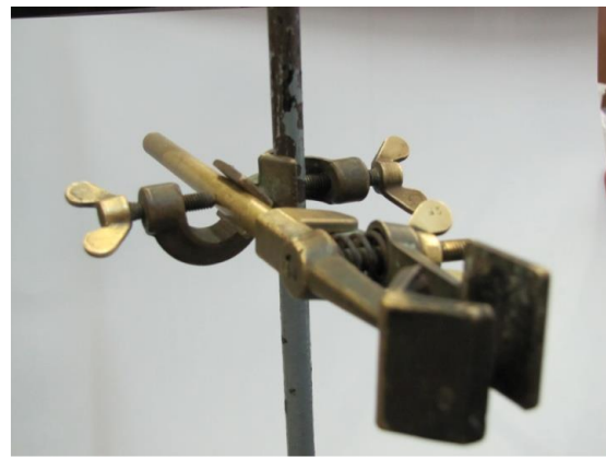
Slika 2. Način postavljanja hvataljke (okrugle ili uglate) u stezaljku na stalku
