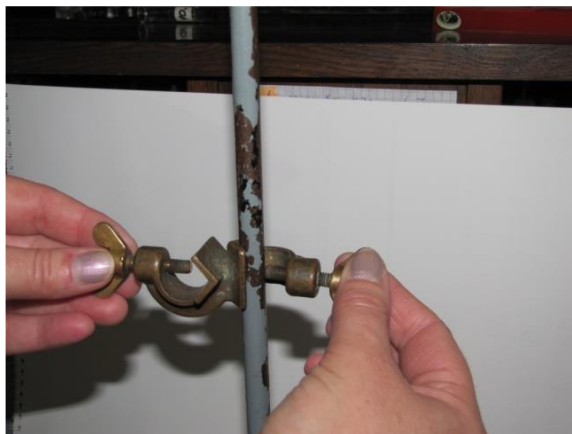
Slika 1. Način postavljanja stezaljke (mufe) na stalak
