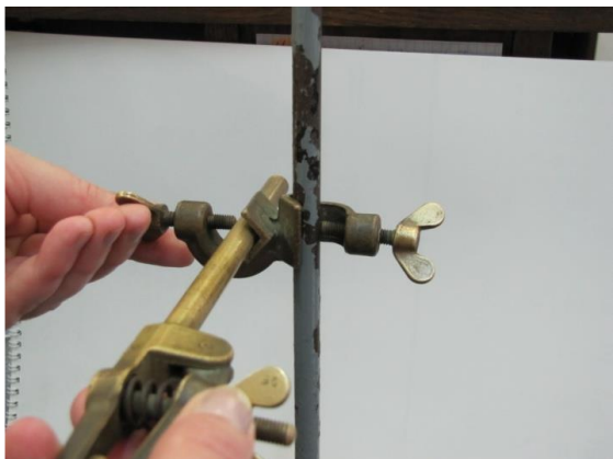
Slika 2. Način postavljanja hvataljke (okrugle ili uglate) u stezaljku na stalku
