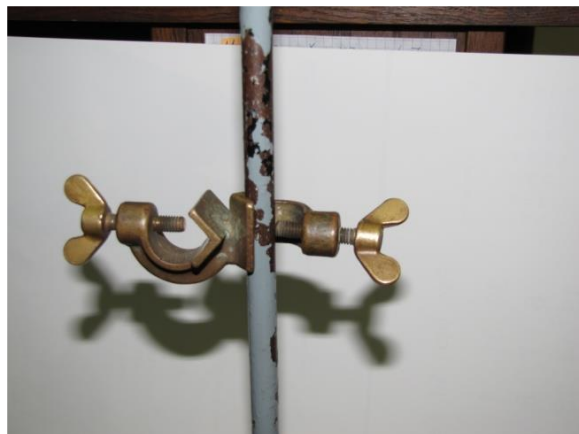
Slika 1. Način postavljanja stezaljke (mufe) na stalak
